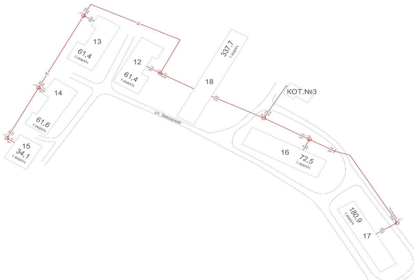
Рисунок 8– Схема тепловых сетей котельной №3 п.г.т. Новосемейкино
