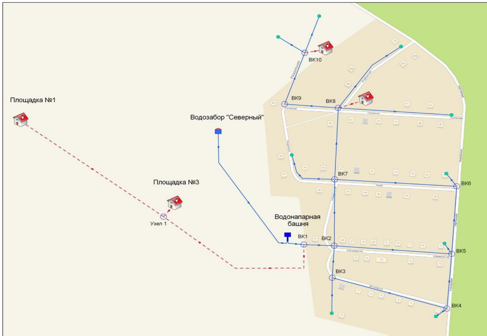
Рисунок 2.4.9.2 – План водопроводных сетей северо-западной части поселка с учетом объектов перспективного строительства, после выполнения мероприятий по строительству и реконструкции сетей
