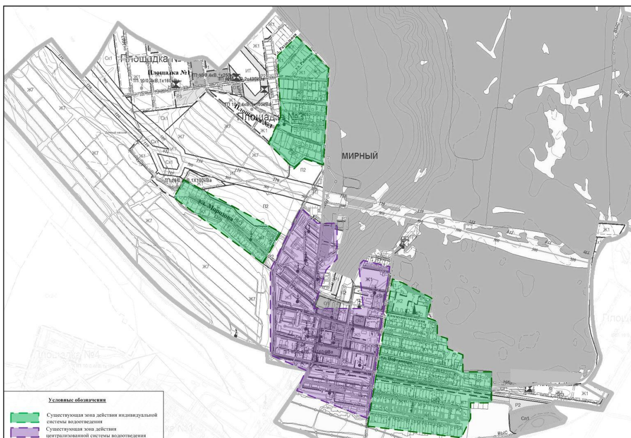
Рисунок 3.1.3.1 – Зоны систем водоотведения п.г.т. Мирный
