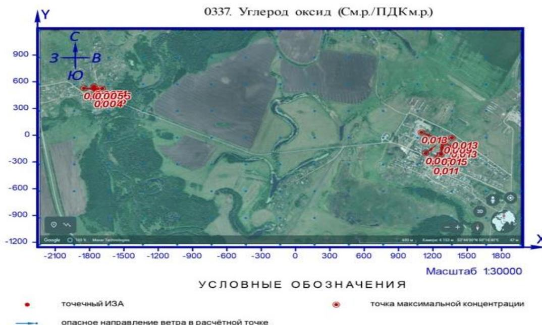
Расчёт рассеивания: 0337. Углерод оксид (Сс.г./ПДКс.с.)
